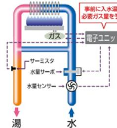
入水量(水量センサー)と出湯量(サーミスタ)からの信号およびその時のガス量を電子ユニットのマイコンで瞬時に演算し、入水温度と必要ガス量を予測することで、安定した出湯量を実現。
